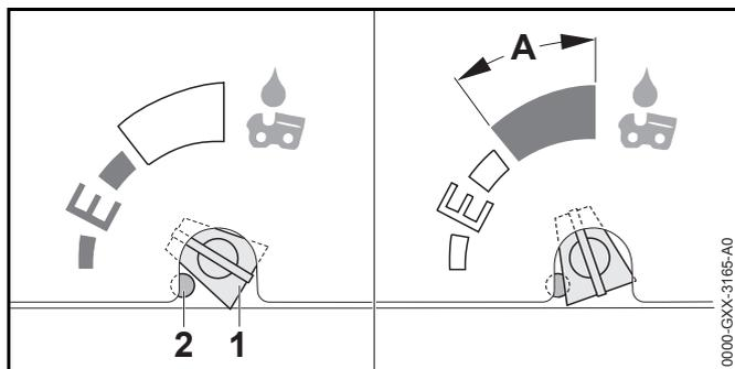
Falls die Ölpumpen-Einstellschraube (1) in Position E (Ematic) steht, ist die Ölfördermenge für die meisten Anwendungen optimal eingestellt.
